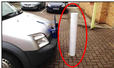
1 m langer Pfosten vor einer in 0,6 m Höhe montierten Kamera
